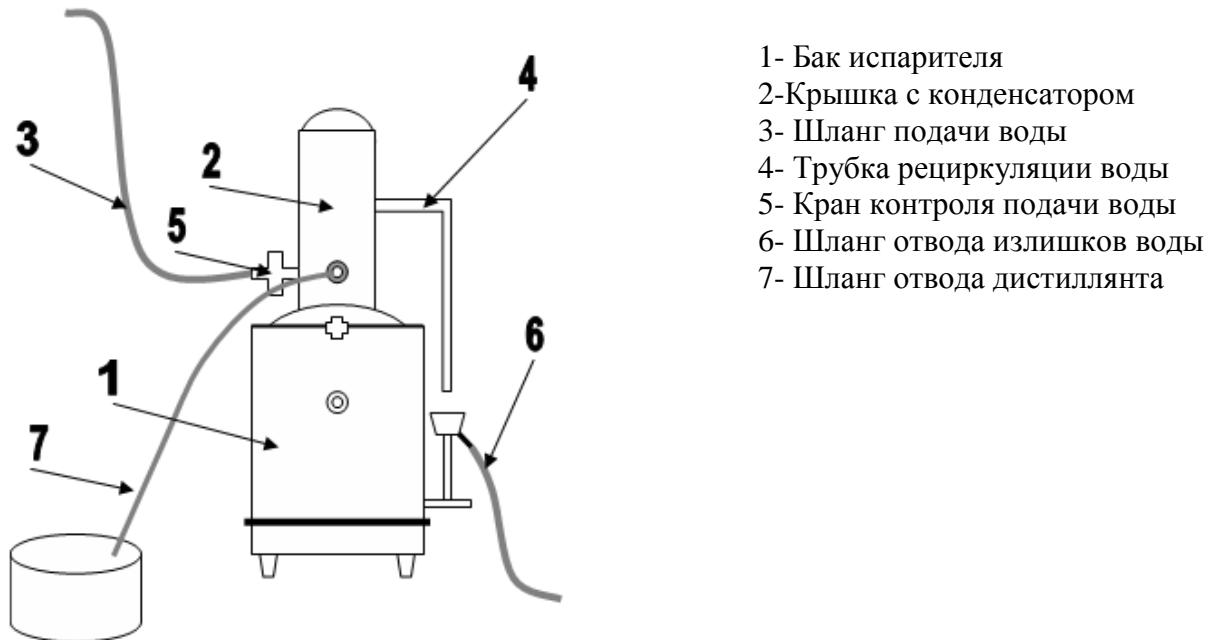
6.6. Схематичное изображение и элементы управления аквадистиллятора модели АЭ-14-«Я-ФП»-03
